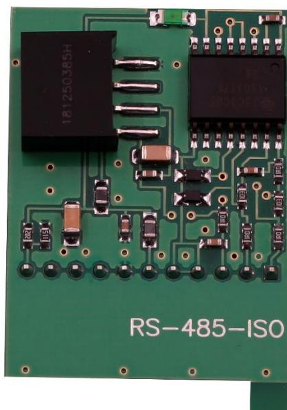
Рисунок 8. Плата преобразователя уровня RS-485-ISO
