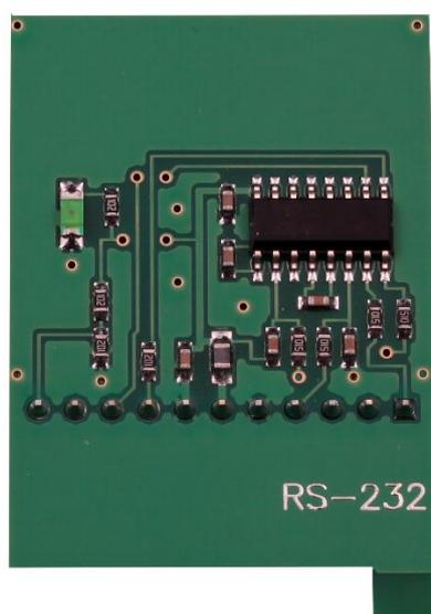
Рисунок 7. Плата преобразователя уровня RS-232
