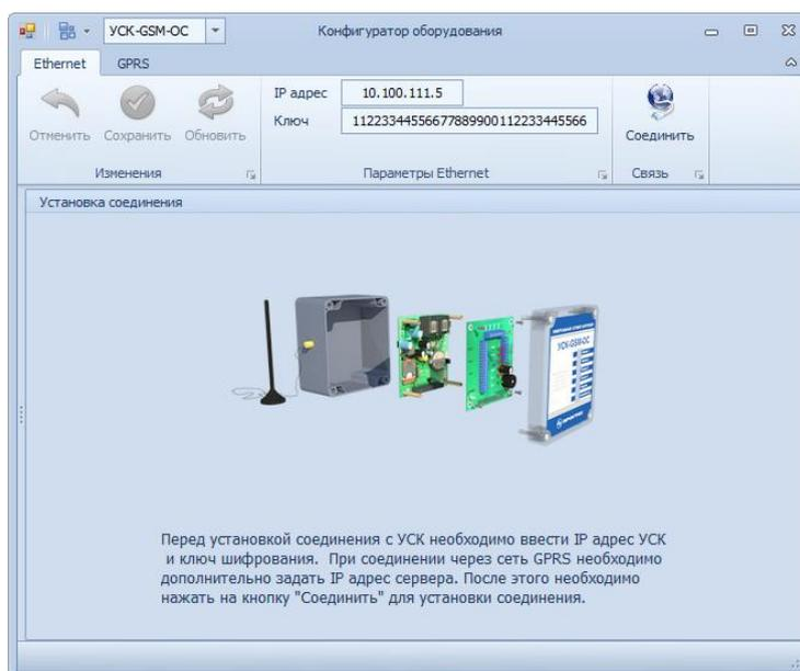
Рисунок 4. Главное окно программы «Конфигуратор оборудования»
