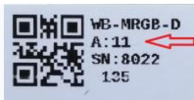
Modbus-адрес, установленный на производстве
