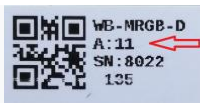
Modbus-адрес, установленный на производстве
