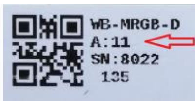
Modbus-адрес, установленный на производстве
