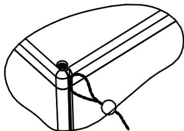
Пример пломбирования ТС на трубопроводе
