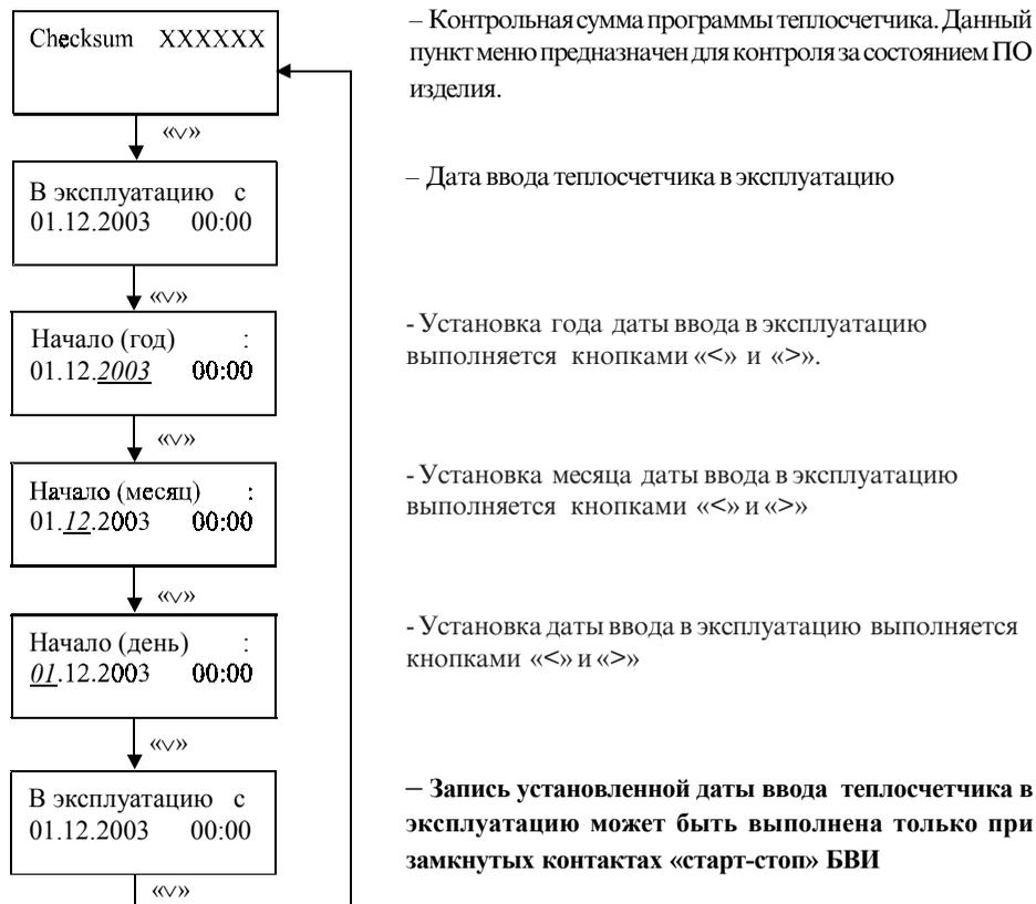
Для выхода в главное меню теплосчетчика нужно нажать кнопку «Esc».
