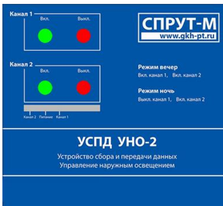
Рисунок 3. Лицевая панель блока управления УСПД УНО-2.
